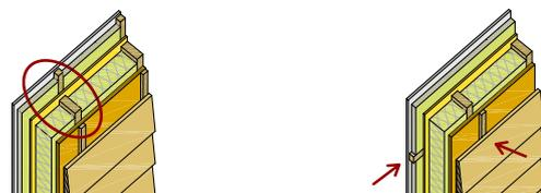
Abbildung 35 Verbesserung der Luftschalldämmparameter der Außenwand von ursprünglich 42 dB (links) auf 49 dB
