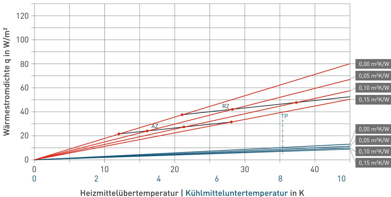
Wärmeleistungsdaten fermacell® Therm25™ Element
