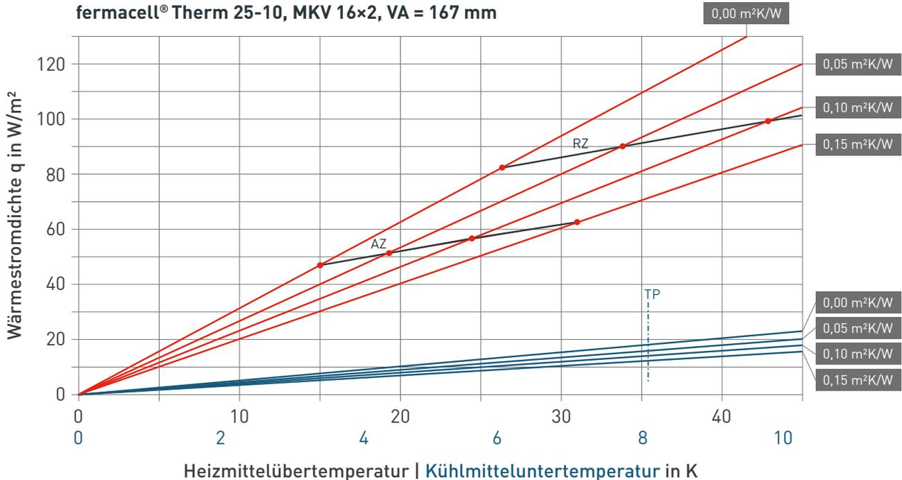
Wärmeleistungsdaten fermacell® Therm25™ Element
