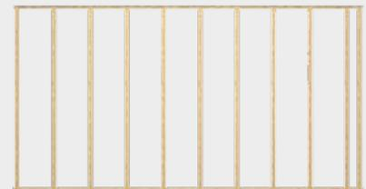
Achsabstand Unterkonstruktion max. 500 mm
