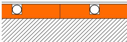
fermacell® Therm25™ Element wird vollflächig auf den ebenen, tragfähigen Untergrund verklebt (Variante 3)
