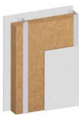
Leichte Metallständertrennwand mit GUTEX Thermofibre®/ GUTEX Thermoflex®/ GUTEX Thermosafe-homogen®
