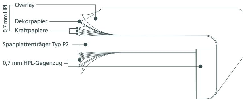
18 mm Qualitätsspanplattenträger Typ P2 nach DIN EN 312 mit 70 mm Abkantung. Oberseite und vordere Kante belegt mit Getalit (HPL) 0,7 mm (Flächenklebung PVAc), Vorderkante abgerundet und bis auf die Unterseite der Abkantung herumgezogen, Radius 10 mm. Rückseitige Kante geschützt (weiße Kante 0,3 mm mit EVA-Klebung). Dekor der Unterseite nach Werkswahl. Rückseite der Abkantung ist durch Gegenzug geschützt.
