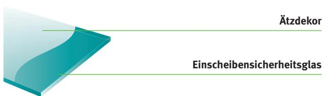
Mit Flusssäure wird die Glasoberfläche mattiert – um Muster zu erhalten werden einzelne Bereiche abgedeckt. Die Glasoberfläche wird mit diesem Verfahren feiner, als beim Sandstrahlen. Die Mattierung kann durch unterschiedliche Einwirkzeiten und Säurearten variiert werden.
