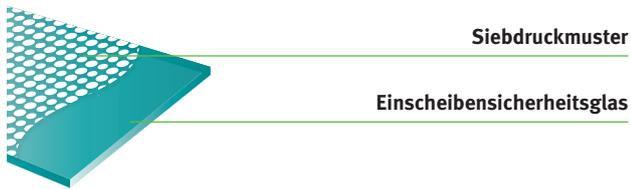
Bei der Herstellung des Siebdruckdesigns werden keramische Farben auf das Glas gedruckt und anschließend eingebrannt.
