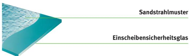
Beim Sandstrahlen wird spezielles Strahlgut unter hohem Druck auf die Glasoberfläche geschleudert. Die Oberfläche wird mattiert, aber lichtdurchlässig. Auch hier werden einzelne Bereiche abgedeckt, um Muster zu erhalten. Die Strahlgutkörnung kann variiert werden, um Schattierungen und Weißabstufungen zu erhalten.
