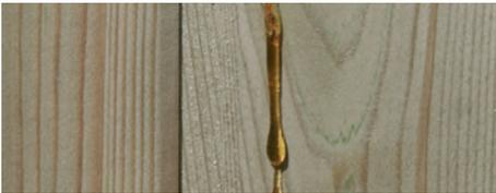
Holz verändert sich durch Lagerung und Verarbeitung im Volumen in der Dichte. Ein Phänomen bei Nadelhölzern während dieses Vorgangs ist das Auftreten von Harz an die Oberfläche. Dies ist vollkommen normal und kann im Nutzbereich durch ein Abschaben und vorsichtiges Entfernen mit Hilfe von Terpentin behoben werden.
