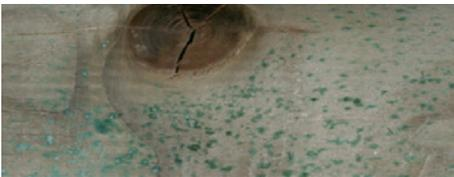
Bei der Kesseldruckimprägnierung dringen Kupfersalze tief in das Holz ein und schützen es vor Schimmel und Insektenbefall. Grün- und weißliche Stellen an der Holzoberfläche sind absolut unbedenklich, da es sich hierbei um Harz handelt, das von den Salzen eingefärbt wurde.
