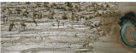
Beim Sägen, Hobeln und Fräsen wird auf eine schonende Verarbeitung geachtet. Holzfasern, die entgegen der Bearbeitungsrichtung verlaufen, führen trotzdem manchmal zu rauen Stellen. Bei Kappschnitten und Kopfrundungen sind kleine Fransen leider nicht zu vermeiden.
