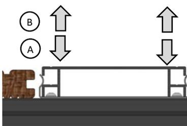
A) Legen Sie das Lüftungsgitter auf die Clips und drücken Sie das Lüftungsgitter beidseitig nach unten bis es einrastet.
