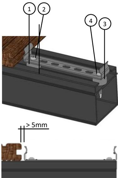
1) Legen Sie eine Distanzhülse an der gewünschten Position in die Profilschiene
