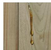
Holz verändert sich durch Lagerung und Verarbeitung im Volumen und in der Dichte. Ein Phänomen bei Nadelhölzern während dieses Vorgangs ist das Austreten von Harz an die Oberfläche. Dies ist vollkommen normal und kann im Nutzbereich durch ein Abschaben und vorsichtiges Entfernen mit Hilfe von Terpentin behoben werden.
