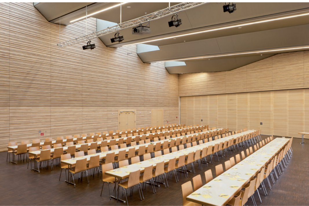
KULTURHALLE ERTINGEN – Zoll Architekten, Stuttgart HABIS-Weißtanneobjektleisten, Keilgezinkt, Astrein, 3 Querschnitte im Tiefenversprung, 40 x 35/45/55 mm
