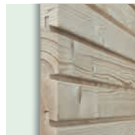
Rhombus-Doppelprofil 28 x 146 mm, mit Nut und Feder
