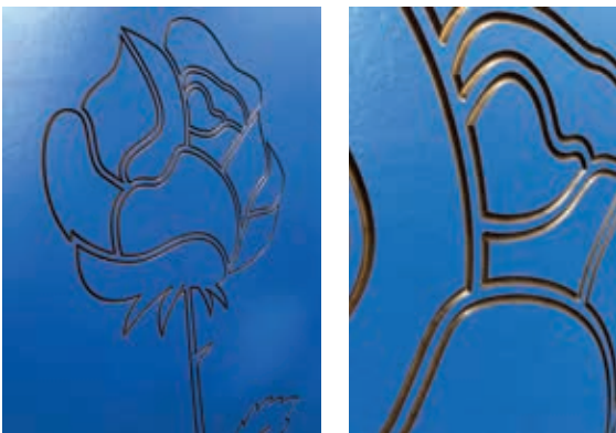
Beispiel einer Fräsung auf einer HPL-Platte
