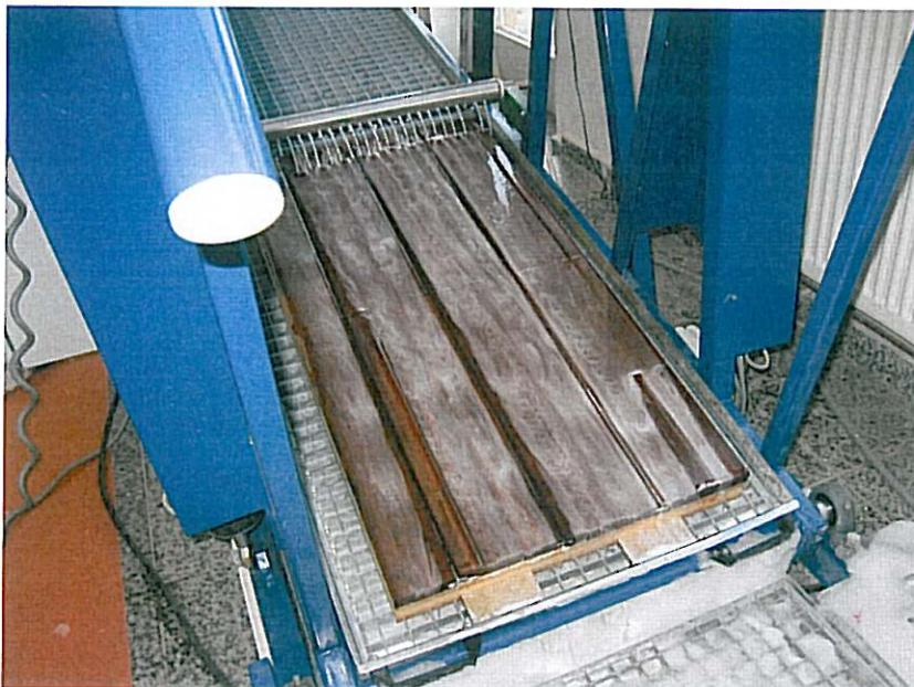
Abb. 1: Bodenbelag (Beispiel) auf Prüfgerät „Schiefe Ebene“
