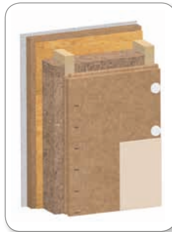
Putzfassade mit Installationsebene
