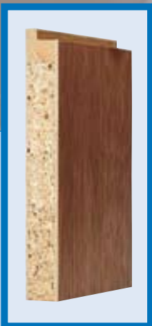
OP1, Türdicke ca. 39 mm, Vollspaneinlage, SSK1, RwR = 27 dB
