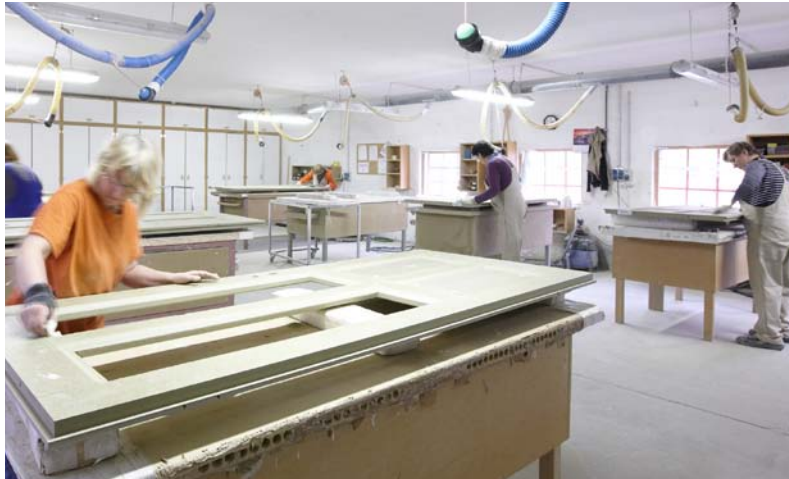
1. Schritt – Erster Schliff an der rohen Tür
