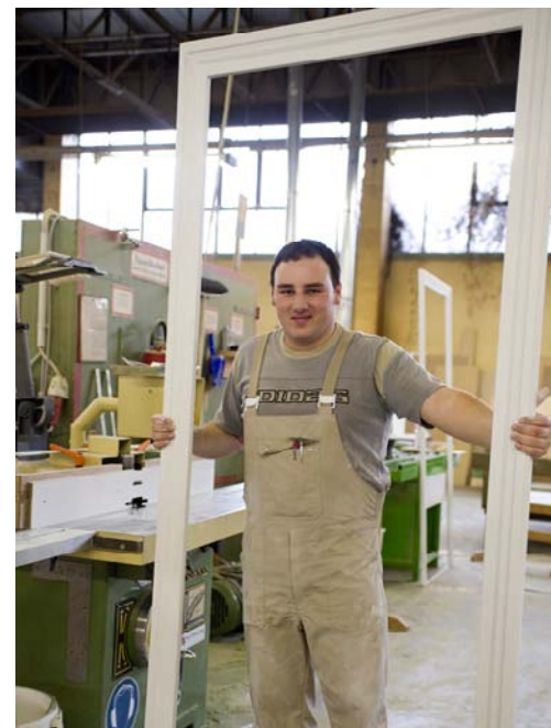
Premiumzarge: Bekleidung aus einem Stück
