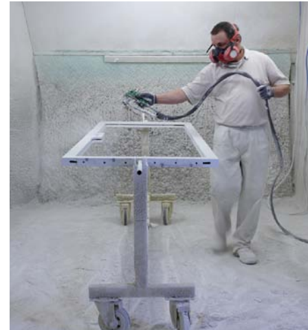
2. Schritt – Erste Grundierung
