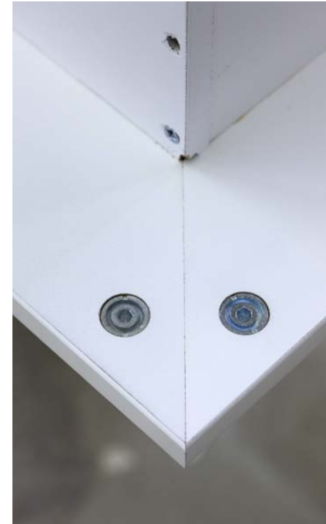
Die Eckverbindungen sind besonders wichtig. Sie bekommen ihren Halt durch Elepart oder alternativ durch Möbelverbinder.
