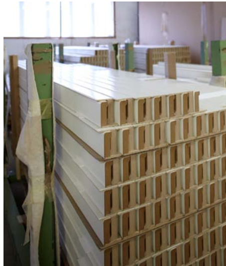
Bekleidung für 22 mm oder alternativ für 28 mm Laibung
