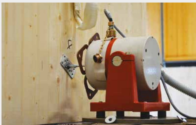
Prüfkonfiguration der Schallübertragung an einer vertikalen X-Verbindung
