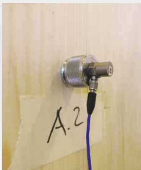
Prüfkonfiguration der Schallübertragung an einer vertikalen X-Verbindung
